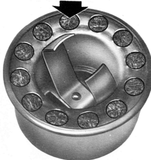
Fig. 2 — Tampa do bocal de enchimento de óleo do carter
