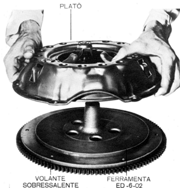
Fig. 5 — Ferramenta de ajuste das alavancas de debreagem
