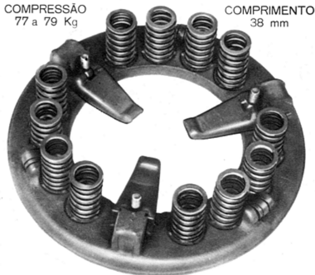
Fig. 4 — Instalação das molas
