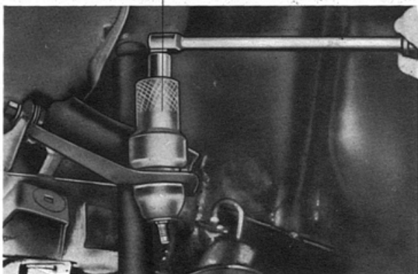
Fig. 25 — Remoção da junta esférica superior
